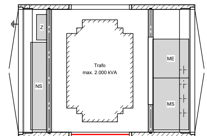
W3828 bis 2.000 kVA
